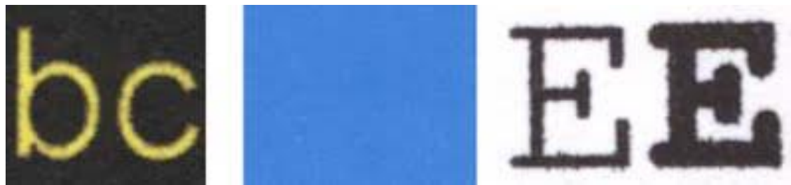
Razlivanje črnila (levo), neenakomernost odtisa (sredina) in nazobčanost robov predmetov (desno)
