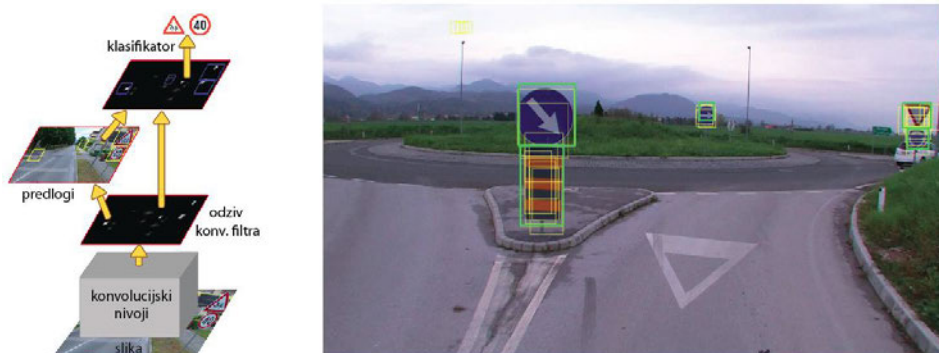
Slika 2: Shema poenotene mreže za detekcijo in razpoznavanje Faster R-CNN (levo). Primer detekcije predlogov regij in klasifikacije predmetov (desno).
