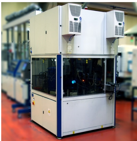
Slika 1: Stroj za optično kontrolo komutatorjev zasega 9 krat manjšo površino kot delavna mesta za očno kontrolo
