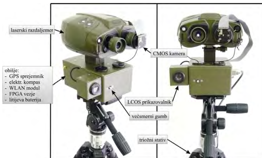
Slika 1: Prenosna izvedba merilnega sistema za določanje položaja oddaljenih objektov.
