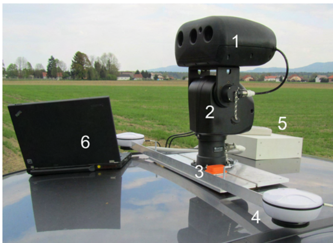
Slika 2: Mobilna izvedba merilnega sistema: (1) ohišje z laserskim razdaljemerom in kamero, (2) motorizirano podnožje, (3) elektronski inklinomer, (4) antena GPS, (5) močnostni in komunikacijski vmesnik in (6) prenosni računalnik.
