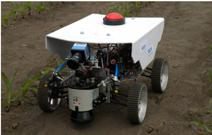
Slika 1: Avtonomni poljedelski robot med vožnjo na polju.
