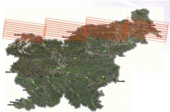
Slika 5: Primer usmerjanja satelita za zajem slikovnega materiala z več prehodi.
