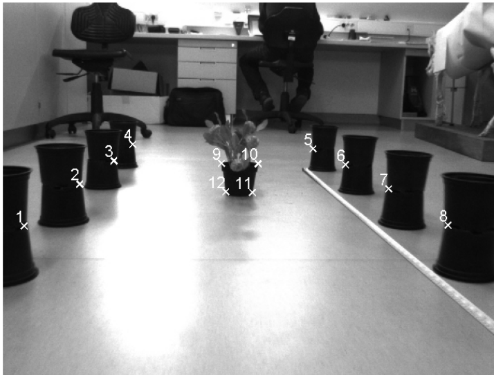
Slika 5: Ročna izbira testnih točk v eksperimentalnem okolju: točke so izbrane na lokacijah, za katere so na razpolago tudi referenčne laserske meritve.
