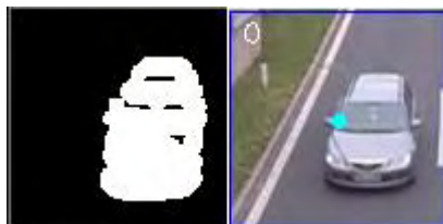
Slika 1: Binarizirana slika, dobljena z metodo odštevanja ozadja (levo) in slika posnetka (desno).
